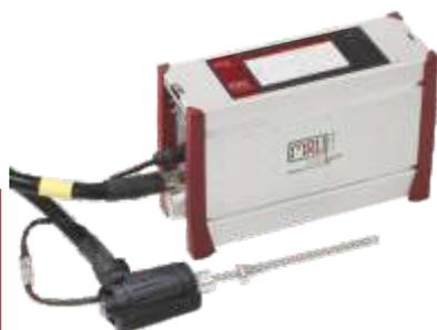
Alta precisão, analísador portátil de gases de combustão por infravermelho com sistema completo de condicionamento de amostras para todas as indústrias, laboratórios e centros de pesquisa.
