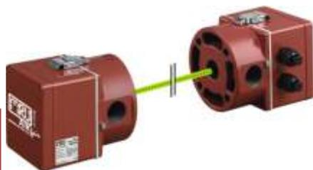
Opacímetro ideal para monitoramento de particulados dos gases de combustão nos condutos e chaminés de sistemas de combustão industrial. Transmissor e receptor com tecnologia micro processado. Medição em  $\text{mg}/\text{m}^3$ . Purga de ar contínua. Configuração se saída em PC, transmissão de dados 4-20 mA., saída análoga em RS 485 protocolo RTU Modbus. Interface para PC - USB ou RS 485. Opacidade de 0-100%
