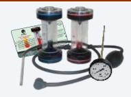
Kit para análise de O2 + CO2; coletor de gás; termômetro com haste de 200 mm. 0...500°C; tabela de % eficiência e perdas da combustão (CO2) para Gás Natural e GLP; fluídos para O2 / CO2.
