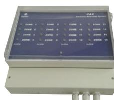
**Central de Monitoramento CAX** para interligação de Detectores GSA 10 para até 16 canais, provida de Sinal Sonoro e Visual e Saída Relé. Indica a zona do vazamento para tomada de decisões. Comunicação á Quadro de Incêndio ou CLP.
