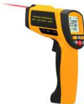
Termômetro digital Infravermelho para altas temperaturas até 2200°C (3992°F). Relação de distância 80:1, Interface RS-232, Emissividade ajustável 0,1~1,00 pré definido 0,95. Resposta espectral 900-1700nm. Grande display LCD com 3 níveis de indicação de bateria. Função de retenção de dados/recuperação. Temperatura selecionável °C/°F. Alarme de temperatura alta/baixa. Funções Máx/Min, Média e Diferencial. Laser Pointer On/Off.
