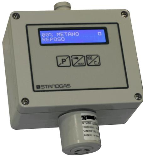
Detector programável autônomo projetado para a detecção de gases inflamáveis usando tecnologia catalítica (pellistor), com uma faixa de detecção de 0 a 100% L.E.L. e resistente a vapores de silicone. Fornecido com um display retroiluminado de 16 X 2 linhas, três teclas, saída de relé de alarme programável e acústica interna.
