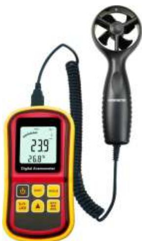
Anemômetro multifuncional provido de display LCD com 2 níveis de luz de fundo, ampla faixa de medição de velocidade do ar 0-45 m/seg.(0~8800ft/min.) com dispositivo de medição a distância. Medição de velocidade e temperatura simultânea (apenas mod: BE 836+). Multiplas unidades de velocidade: m/s , Km/h , ft/min , mph , nós. Velocidade exibida em porcentagem com barra gráfica. Medições de Máx./Min. Desligamento automático.
