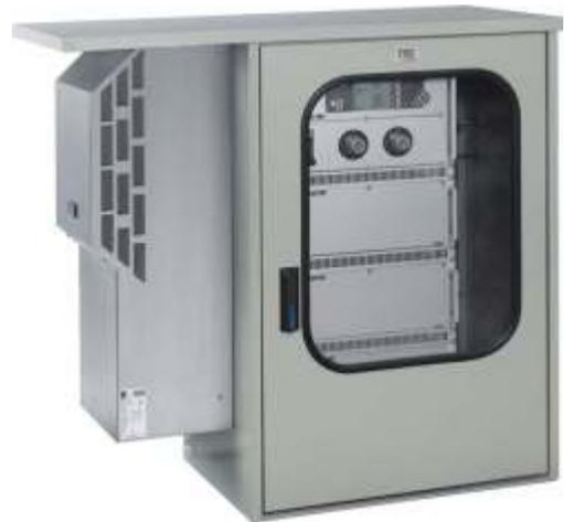
O Analísador de gases SWG 300-1 é baseado no método de extração a frio, seca e utiliza módulos NDIR, que medem de forma contínua, seletiva e altamente exata. O NO<sub>2</sub> é cataliticamente convertido em NO, determinação verdadeira do NO<sub>x</sub>. A análise de oxigênio é baseada em célula de zircônio, célula paramagnética, ou célula eletroquímica.
