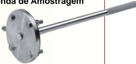
Sonda em aço inoxidável até 900°C com flange DN 65 PN 6 e filtro sinterizado de 3 microns para particulados da combustão.
